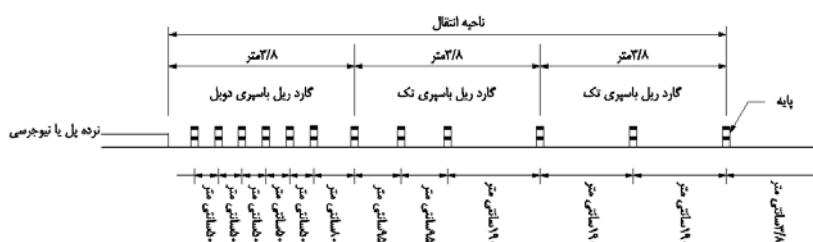
ب- ناحیه انتقالی بین حفاظ دو موج و حفاظ نیوجرسی یا نرده پل
