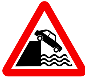
شکل ۳-۴۵ - خطر سقوط در آب
