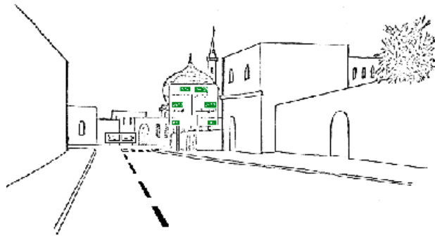
شکل ح-۱- نصب نامطلوب علامت باعث شلوغ شدن خیابان و از بین رفتن دید شده است
