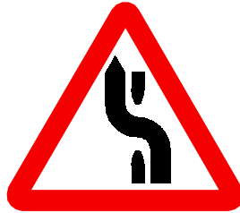
شکل ۳-۶۳- انتقال مسیر ترافیک در راه میانه‌دار
