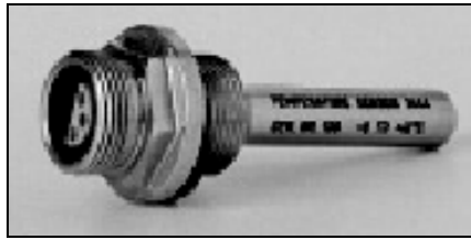
شکل (۲-۱۱) سنجنده دمای زیر سطح جاده (حییبی نوخندان، ۱۳۸۴)
