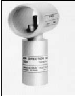
شکل (۸-۲) سنجنده جهت جریان هوا (حبیبی نوخندان، ۱۳۸۴)
