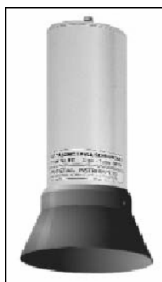
شکل (۲-۵) سنجنده ارتفاع برف (حبیبی نوخندان، ۱۳۸۴)
