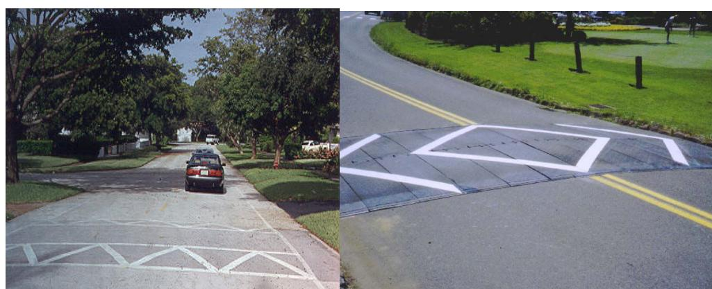
شکل ۴ - نمونه‌ای از سرعت‌گیرهای آسفالتی (سرعتکاه قوسی و سرعتکاه تخت)
